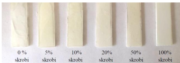
Rys. 3. Zdjęcie otrzymanych kompozytów na bazie TEGDMA + MMA z różną zawartością % skrobi.
