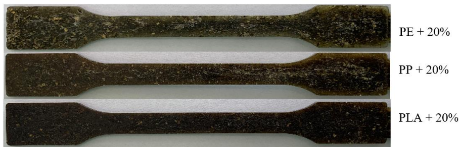
Rys. 1. Wygląd kompozytów o zawartości 20% wag wypełniacza.
